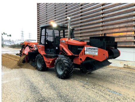
Trancheuse DW RT 125 déportable de droite à gauche 15 cm de large 100 cm en profondeur
