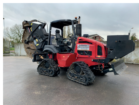
Trancheuse TORO 1200 Q déportable de droite à gauche 20 cm de large 100 cm en profondeur
