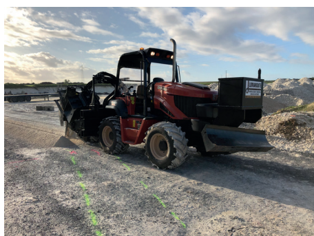
Trancheuse DW RT 120 ou RT 115 déportable de droite à gauche 15 cm de large 80 cm en profondeur
